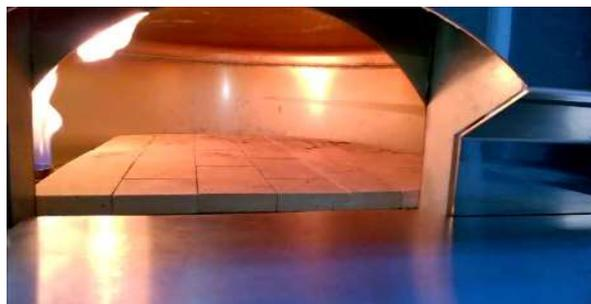
*Piano di cottura in refrattario fisso*
